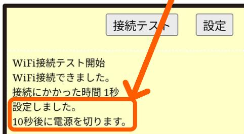
「設定しました」と表示されたら設定完了です。設定が終わると自動的にI-BOXの鍵が解錠されます。その後約10秒ほどで電源が切れ、LEDが消灯します。
